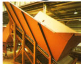
Tiefbunker in Einzelaufstellung
