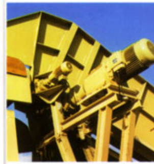
Übergang auf Gurtförderer mit Beschleunigungsrolle mit Eigenantrieb
