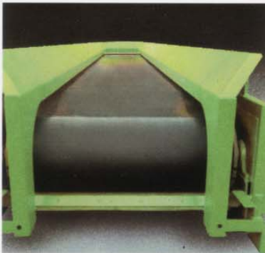
Abb. 4: Gurtförderer mit integrierter Metallsuchspule.
